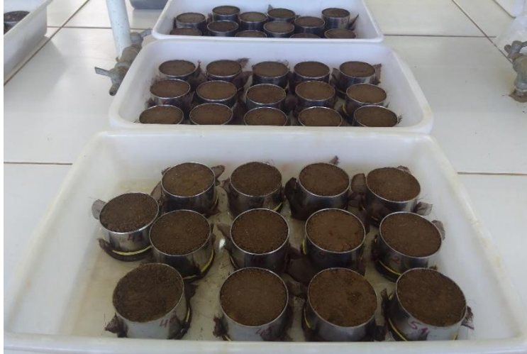
Figura 4 - Anéis volumétricos artificialmente compactados com solo de estrutura alterada, representando densidades que correspondem aos tratamentos de diferentes GC.
