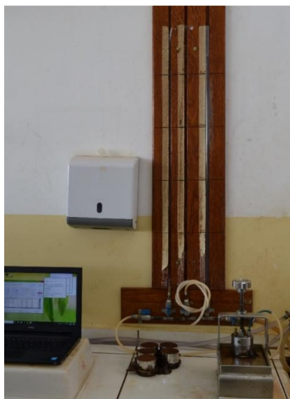
Figura 6 - Realização do teste K_s em permeâmetro de carga variável.
