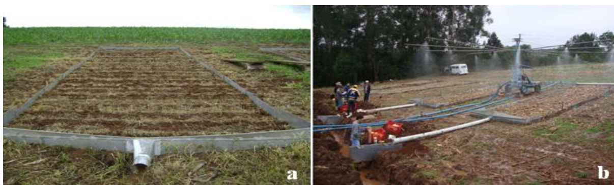
Figura 1 - a) Unidade experimental delimita nas laterais e parte superior por chapas galvanizadas e na parte inferior por calha coletora de escoamento; b) vista do simulador de chuvas operando sobre duas unidades experimentais. Na mesma figura, observa-se a calha coletora de enxurrada conectada ao tubo de PVC que conduzia o fluxo até a câmara com vertedor alocado na trincheira.
