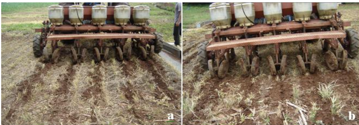
Figura 6 - Semeadura mecanizada realizada sobre o resíduo cultural do trigo com utilização de hastes sulcadoras. a) parcela com 100% da dose de resíduo; b) parcela com 50% da dose de resíduo.
