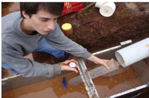
Figura 10 - Medição da taxa de enxurrada na chuva anterior aos fluxos extras.
