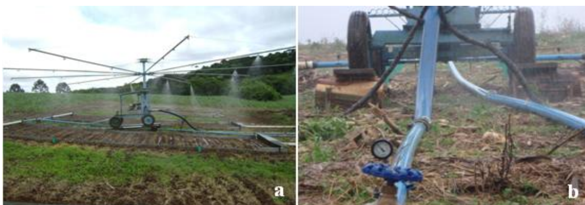
Figura 2 - a) Vista lateral do simulador de chuvas de braços rotativos tipo Swanson; b) controle da intensidade de chuva realizado através de registro e manômetro localizados próximo a entrada de água no simulador.
