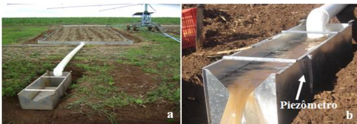
Figura 4 - a) Câmara com vertedor triangular para medir vazão; b) piezômetro utilizado para realizar as leituras de vazão no vertedor.
