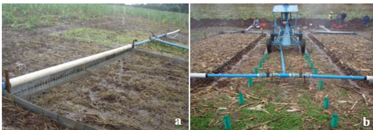
Figura 3 - a) Fluxo extra de água adicionado na extremidade superior de uma parcela simulando comprimento de rampa maior; b) detalhe dos registros utilizados para controlar a entrada de água pelo fluxo extra nas parcelas experimentais. Na figura, também é possível observar os pluviômetros instalados para medição do volume e intensidade real das chuvas aplicadas, anterior a adição dos fluxos extras.
