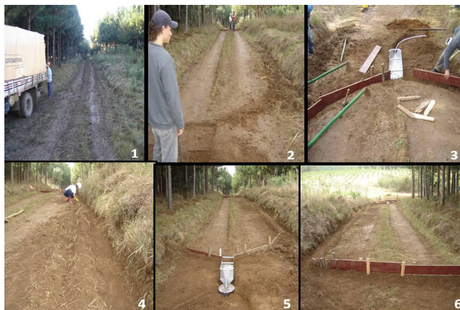
Figura 13 – Sequência de imagens mostrando o procedimento de instalação de uma parcela e da Roda Coshocton. Fonte: produção do próprio autor.
