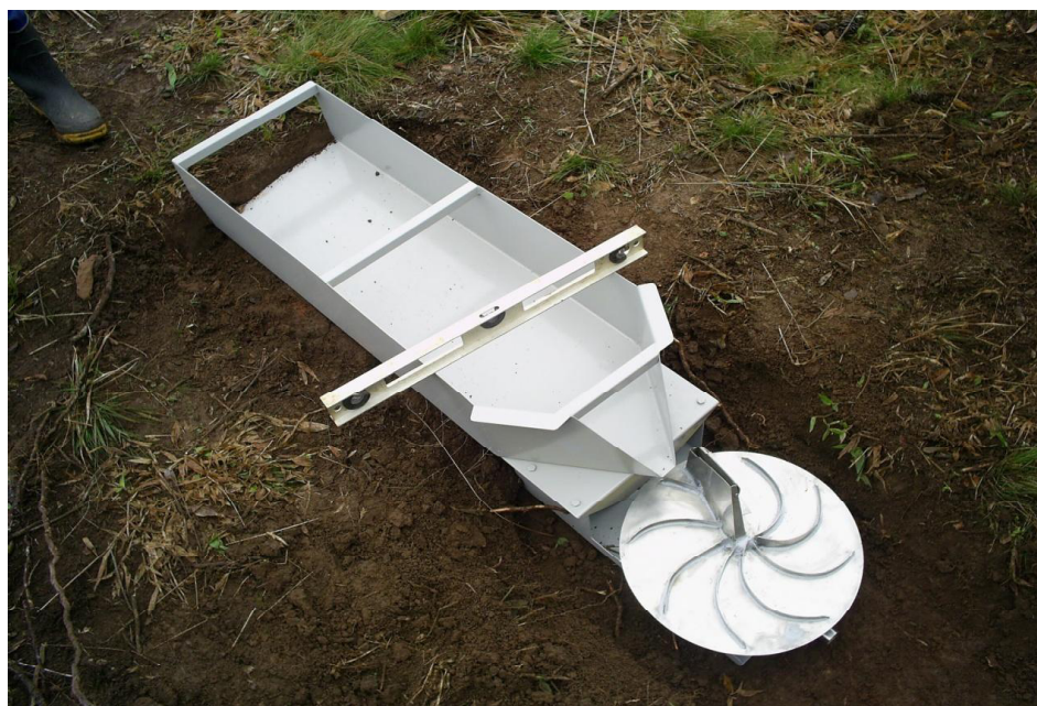
Figura 15 – Aspectos da instalação e nivelamento da Roda Coshocton. Fonte: produção do próprio autor.
