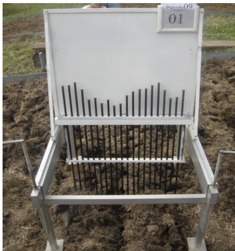
Figura 4 - Rugosímetro de varetas de alumínio posicionado sobre os suportes de madeira sobre a parcela experimental.
