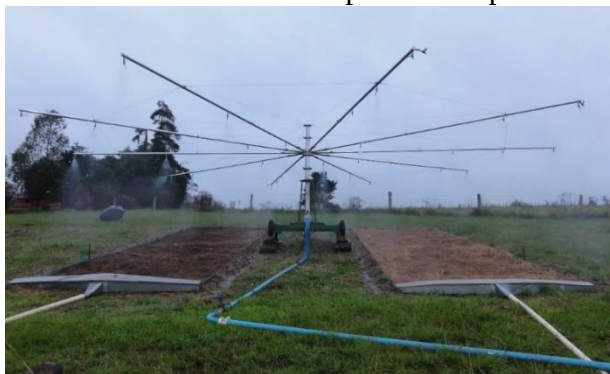
Figura 3 - Simulador de chuva tipo empuxo, cobrindo simultaneamente duas parcelas experimentais.
