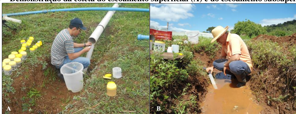
Figura 9 – Demonstração da coleta do escoamento superficial (A) e do escoamento subsuperficial (B).
