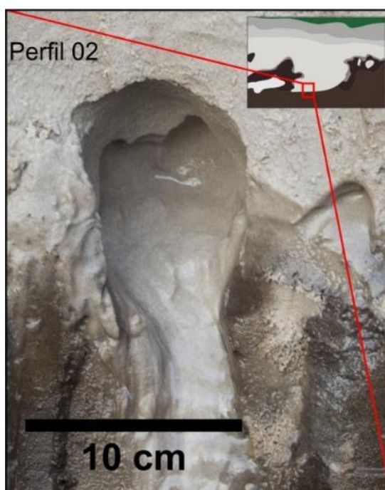
Figura 36 – Detalhe da percolação da água extravasando pela parede do perfil devido a diferença de condutividade hidráulica do horizonte E em relação ao Horizonte Bh.
