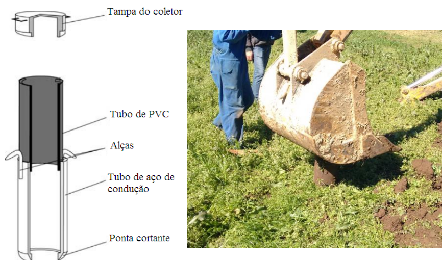
Figura 2.1 - Esquema do amostrador, mesocosmo e amostragem de “terrestrial model ecosystems” a campo.
