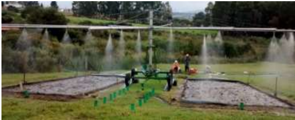
Figura 5 - Simulador de chuva de braços rotativos do tipo empuxo operando sobre duas parcelas simultaneamente
