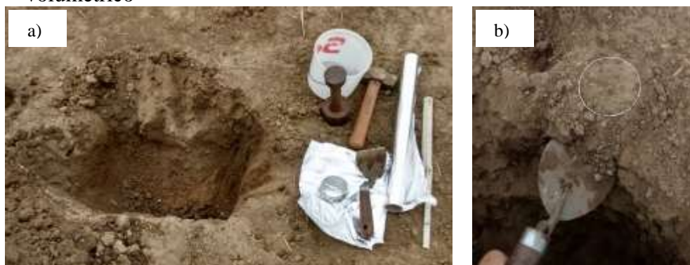
Figura 7 - Coleta de amostra não deformada de solo a) Material utilizado, b) Coleta de anel volumétrico
