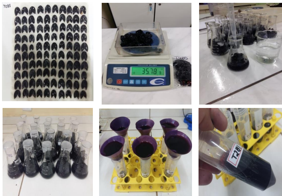
Figura 12 – Ilustração dos procedimentos de extração de cascas para determinação de antocianinas e polifenóis da uva ‘Cabernet Sauvignon’ cultivadas sob níveis de umidade.
