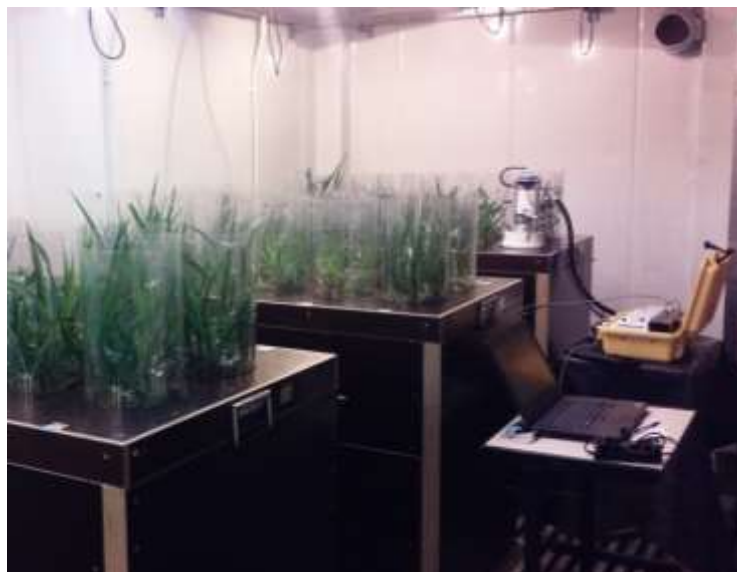
Figura 4.4. 3 - Vista da avaliação do fluxo de CO 2 do sistema com o equipamento Licor LI 8100.
