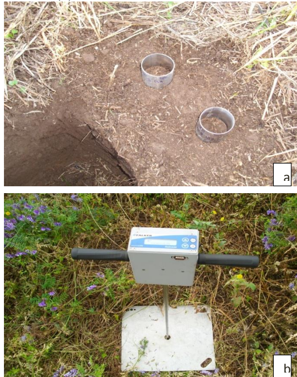
Figura 5 - Coleta de solo em anéis volumétricos (a) e avaliação da resistência do solo à penetração mecânica (b)
