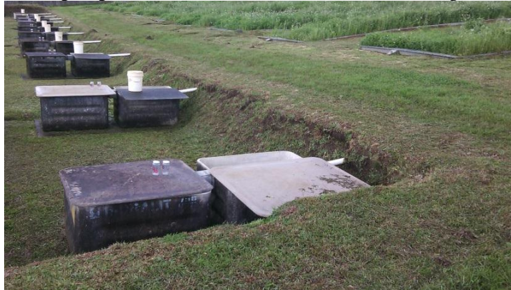
Figura 8 - Coleta de campo após o evento de chuva erosiva em cada parcela
