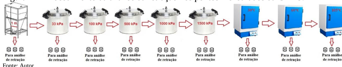
Figura 17 - Procedimento da análise da retração nos pontos mensurados da CRAS.
