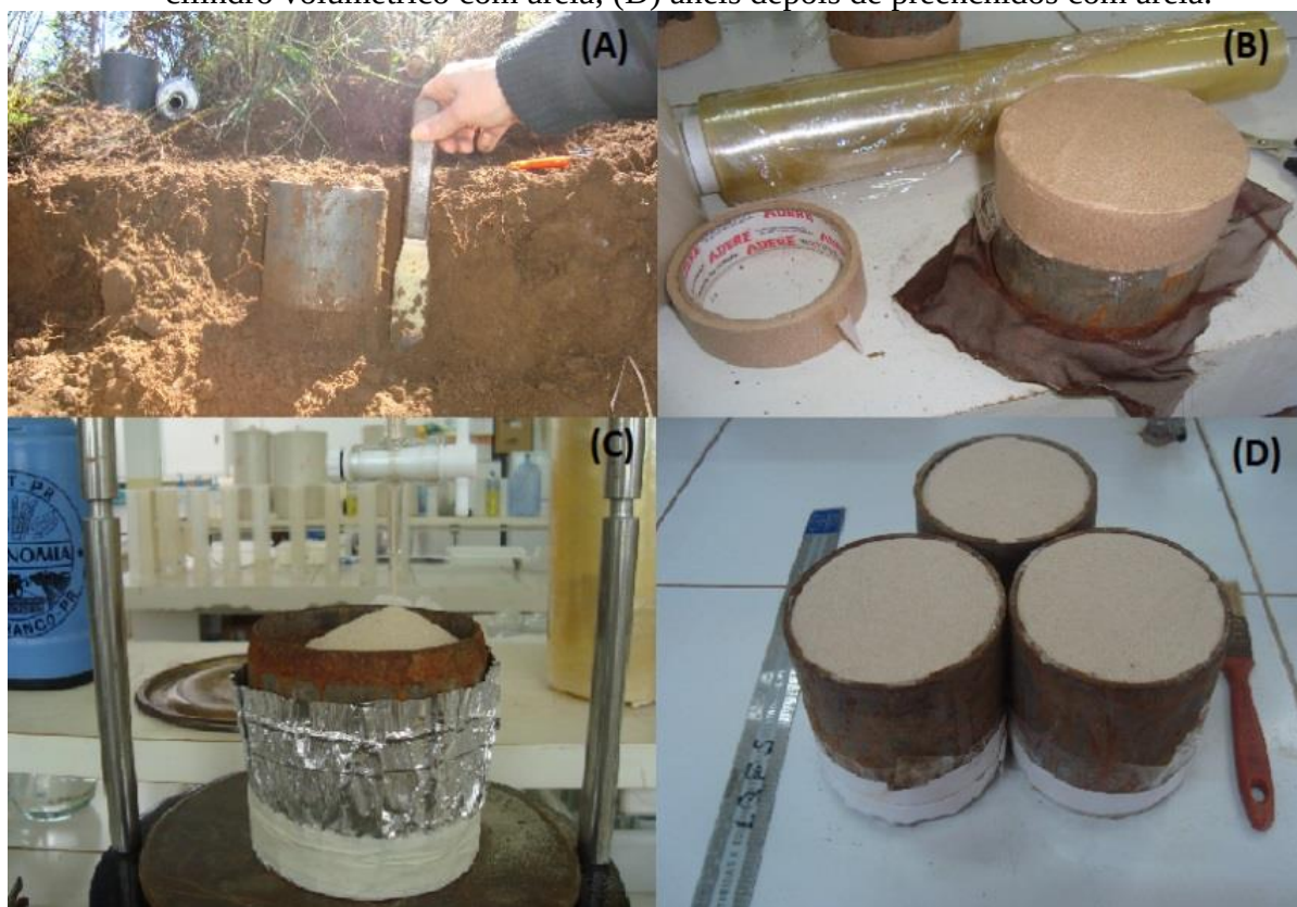
Figura 16 - Método de quantificação da retração do solo: (A) coleta do cilindro volumétrico; (B) vedação da parte inferior do cilindro volumétrico; (C) preenchimento do cilindro volumétrico com areia; (D) anéis depois de preenchidos com areia.
