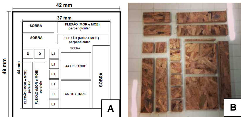
Figura 22 - Layout de retirada dos corpos de prova do painel. A) Desenho e dimensão dos corpos de prova; B) Painel após esquadrejamento e retirada dos corpos de prova.
