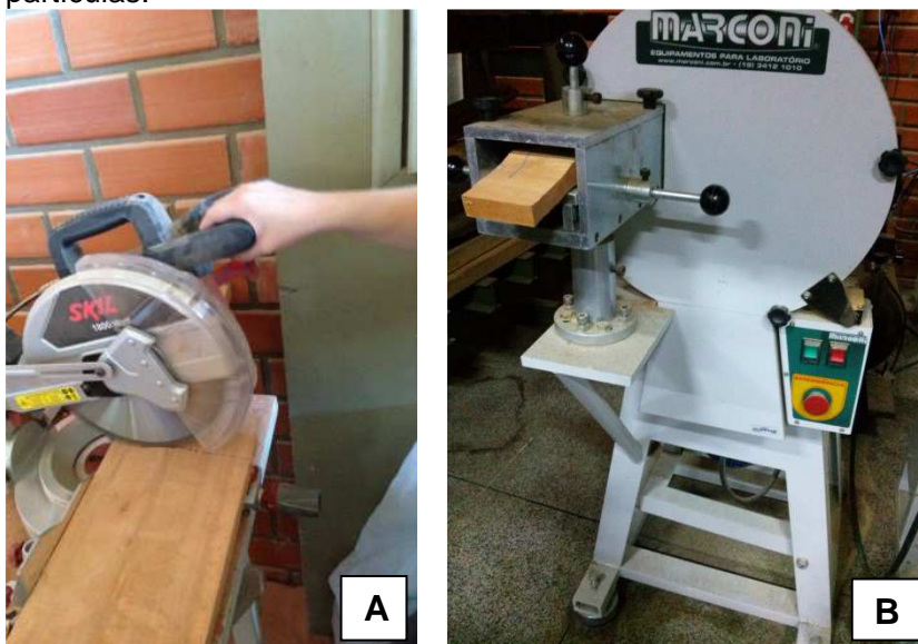
Figura 16 - Processo de preparo e geração das partículas. A) Destopo das peças de madeira serrada. B) Geração das partículas.
