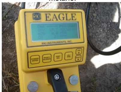
Figura 8 - Aparelho EAGLE da marca RKI utilizado na medição de gás metano.
