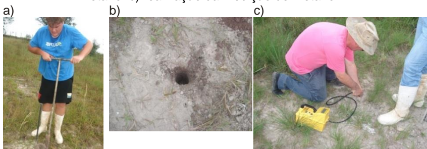
Figura 9 - Medição de metano 40cm abaixo da superfície do solo.a) trado utilizado para realizar furo .b) Furo utilizado para coleta de metano. c) realização da medição de metano.
