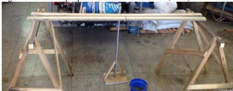
Figura 8 - Classificação pelo Módulo de Elasticidade (MOE)
