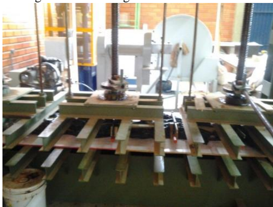
Figura 12 - Prensagem a frio das vigas
