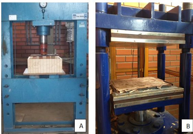
Figura 15 – Prensagem do colchão de partículas. A) Pré-prensagem B) Prensa hidráulica a quente.
