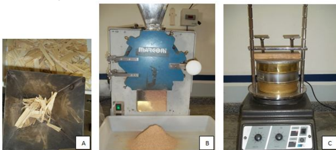
Figura 12 – Preparação do material para análise química. A) Partículas antes do processamento B) Serragem obtida após processamento em moinho tipo Wiley C) Classificação do material em peneira granulométrica.
