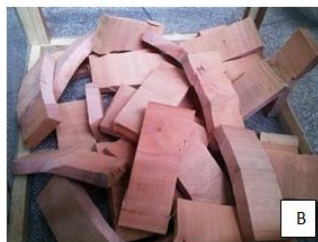
Figura 10 – Geração das partículas. A) Gerador de partículas de madeira. B) Amostra das peças destopadas. C) Partículas geradas.
