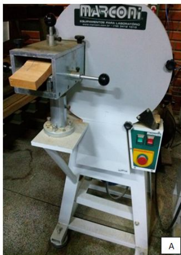
Figura 10 – Geração das partículas. A) Gerador de partículas de madeira. B) Amostra das peças destopadas. C) Partículas geradas.
