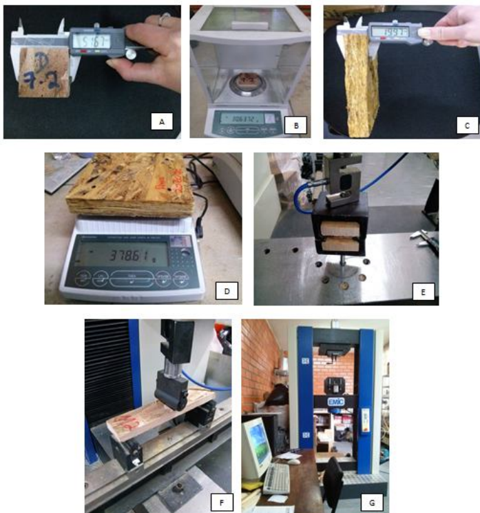
Figura 18 – Ensaio físicos e mecânicos. A e B) Medição e pesagem dos corpos de prova para determinação da Densidade e Teor de Umidade. C e D) Medição e pesagem dos corpos de prova para determinação do Inchamento em Espessura, Absorção de Água e Taxa de Não Retorno em Espessura. E) Ensaio de Ligação Interna. F) Ensaio de Flexão. G) Máquina Universal de Ensaio.
