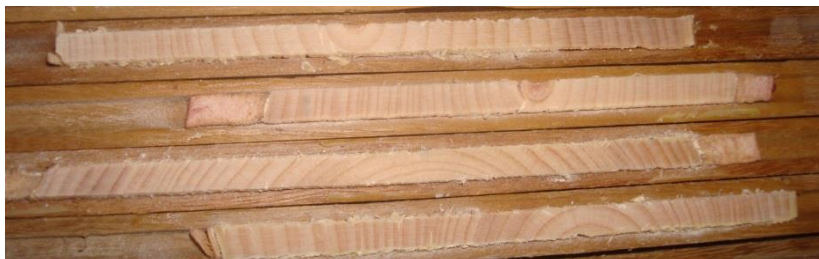
Figura 15 - Amostras lixadas e prontas para marcação dos anéis de crescimento.
