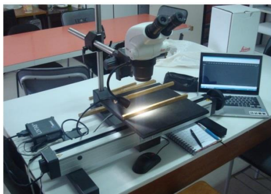
Figura 16 - Mesa de mensuração de anéis (Lintab 6) (A) e amostra sendo medida (B).
