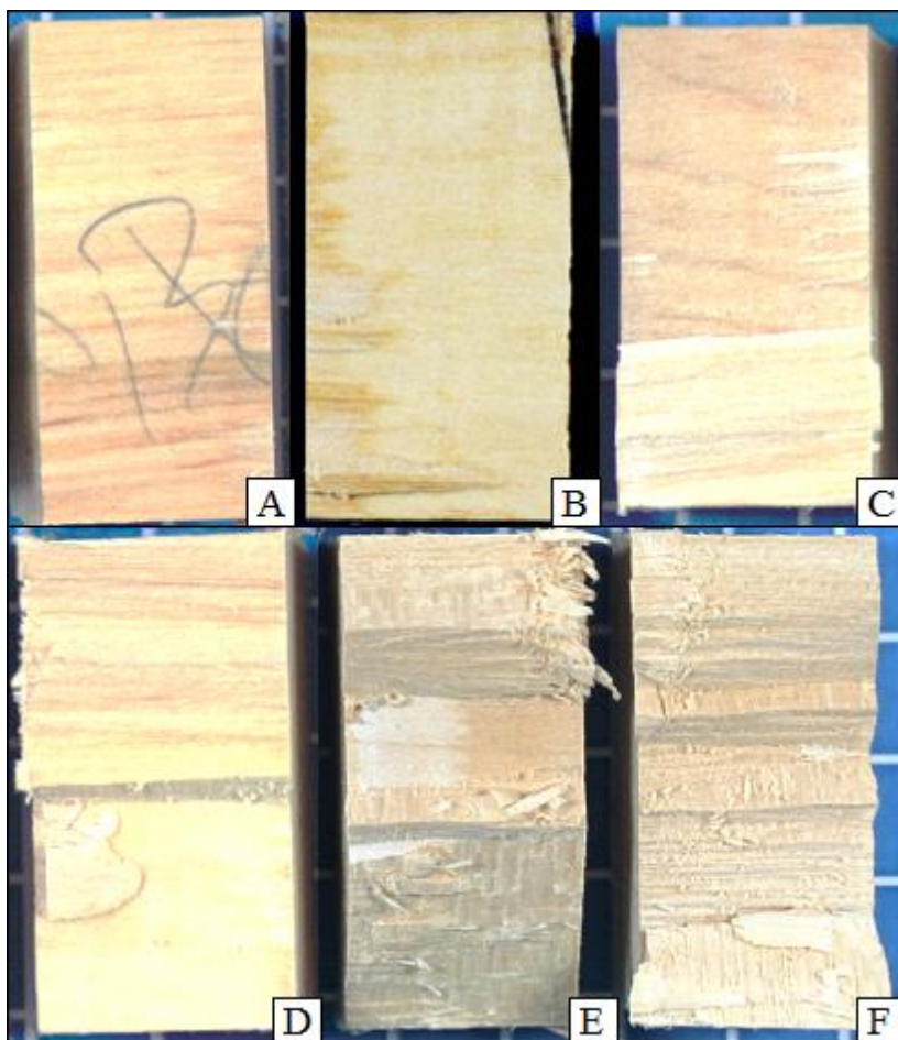
Figura 19 - Percentual de falha na madeira (FM%) observado nas peças de cisalhamento na linha de cola.
