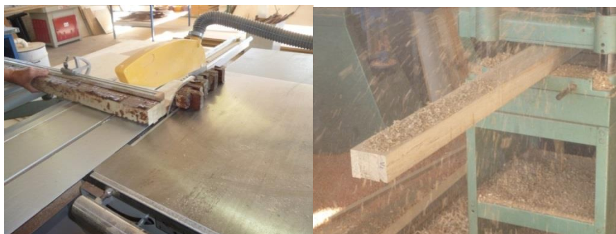
Figura 21 - Acabamento das vigas: a) Destopo; b) Aplainamento
