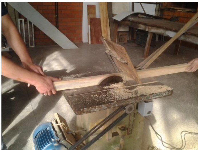
Figura 12 - Esquadrejamento das lâminas
