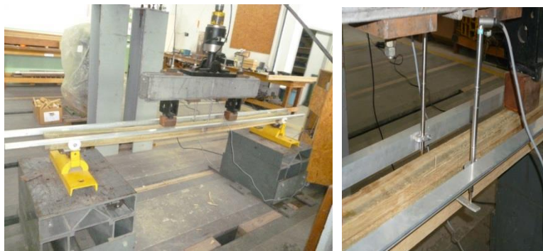
Figura 28 - Teste de flexão: (a) esquema de ensaio a quatro pontos; e (b) posicionamento dos transdutores de deslocamento entre os pontos de aplicação de carga.
