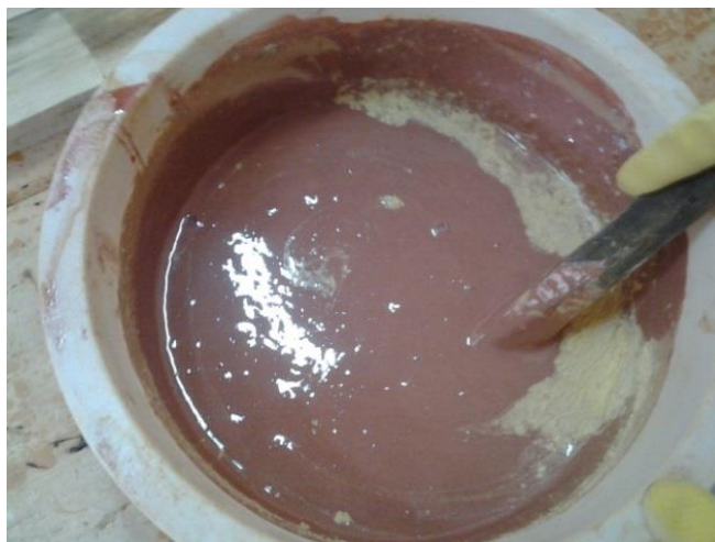
Figura 18 - Incorporação do adesivo e pó endurecedor
