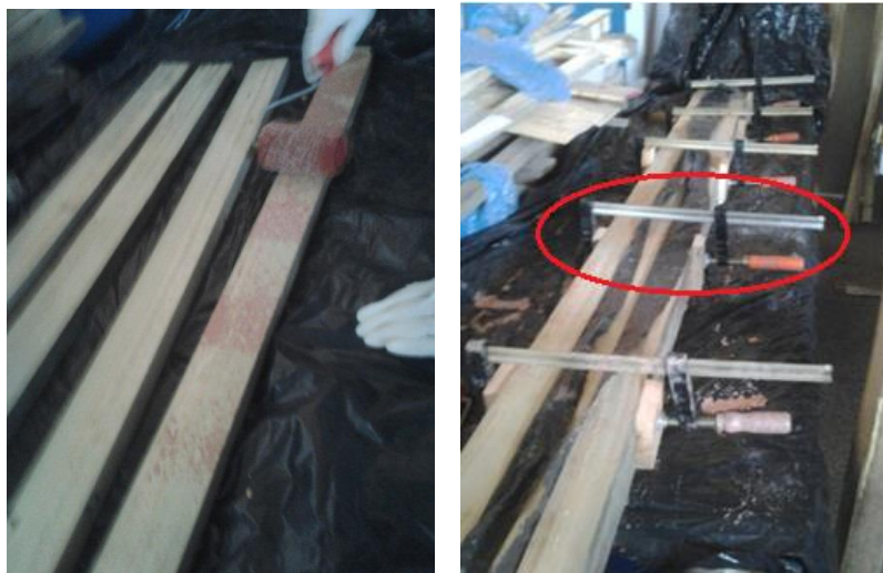
Figura 19 - Confeção das vigas: (a) Aplicação do adesivo; (b) Contenção lateral da viga.
