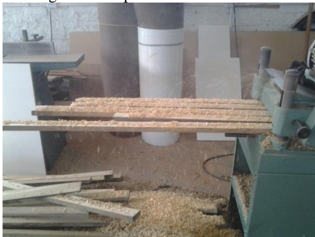
Figura 17 - Aplainamento das lâminas
