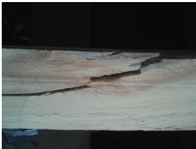
Figura 13 - Peça descartada por rachadura
