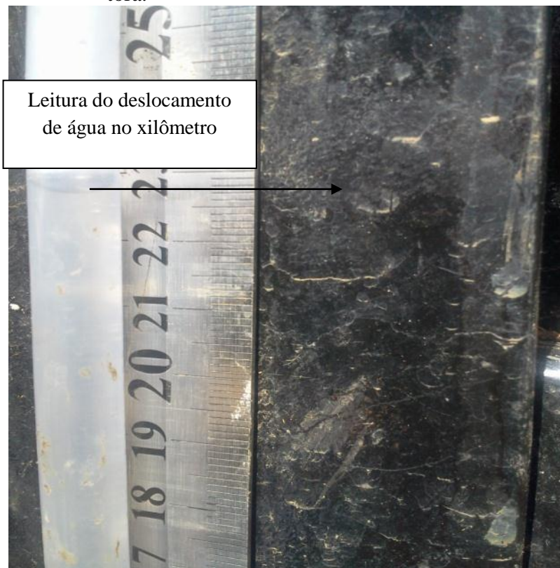
Figura 14 - Leitura do volume do xilômetro após a imersão da tora.
