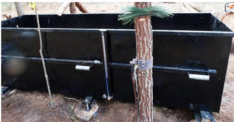
Figura 12 - Xilômetro com capacidade de 3,3\text{ m}^3 , utilizado para determinação do volume por sortimento e volume total das árvores.
