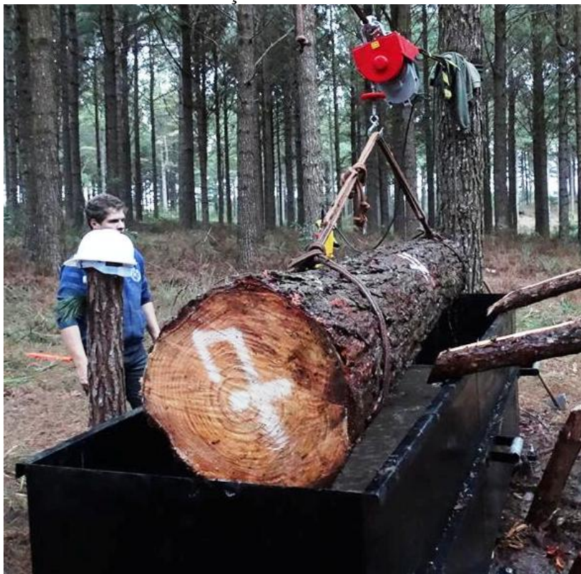
Figura 13 - Imersão da tora dentro do xilômetro para determinação de seu volume.
