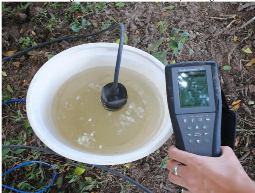
Figura 6 - Sonda multiparâmetros Ysi Professional Plus utilizada na mensuração a campo das variáveis: temperatura, OD, pH, condutividade, salinidade e STD, para a determinação da qualidade da água, na bacia hidrográfica do rio Ponte Grande, em Lages - SC.
