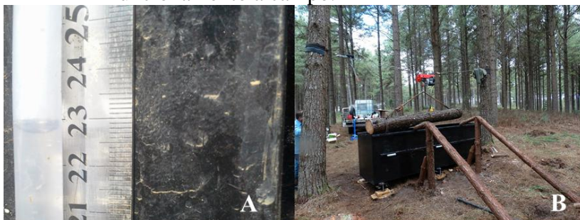
Figura 1 – Xilômetro utilizado no estudo. Sendo: A: leitor das medidas efetuadas no xilômetro. B: xilômetro em funcionamento a campo.
