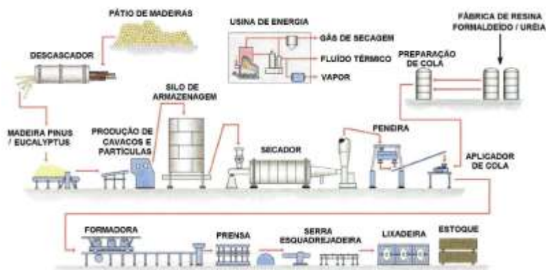
Figura 6- Fluxograma do processo de fabricação dos painéis MDP.
