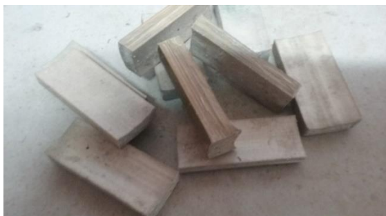
Figura 3 - CORPOS DE PROVA PARA CARBONIZAÇÃO DAS ESPÉCIES Bambusa vulgaris e da espécie Phyllostachys bambusoides
