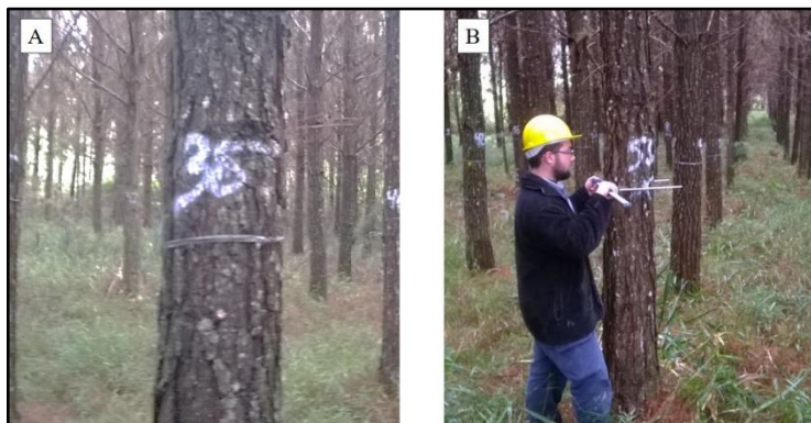
Figura 14 – A) Árvore marcada com tinta e fita na altura do DAP; B) Medição do DAP com suta.
