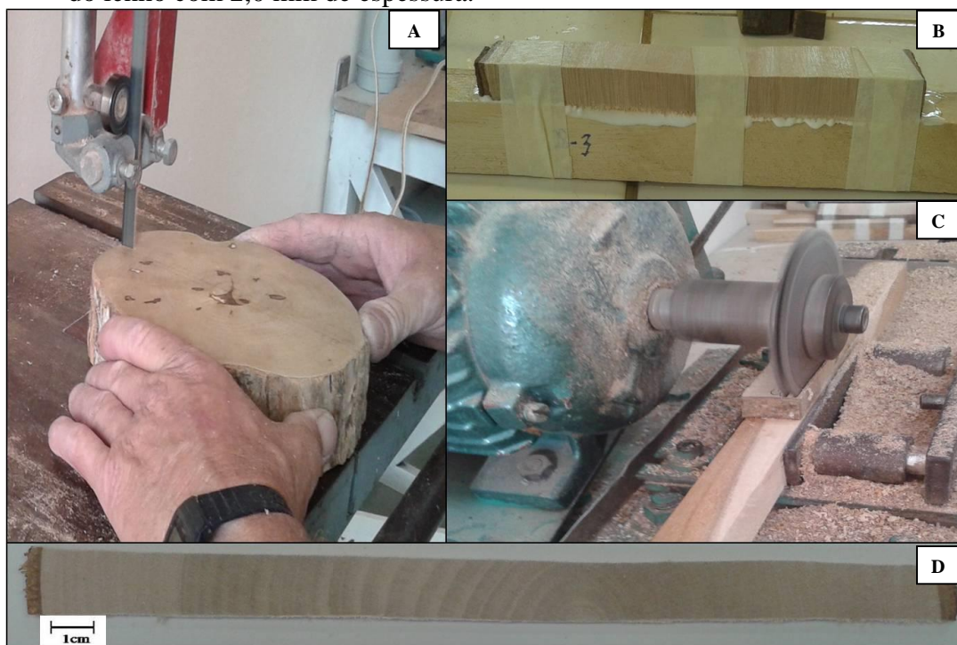
Figura 2 - Preparo do material para densitometria de raios X. (A) corte dos discos para retiradas da amostra do lenho; (B) colagem da amostra do lenho em suporte de madeira; (C) corte das amostras do lenho em equipamento de dupla serra; (D) amostra diametral do lenho com 2,0 mm de espessura.
