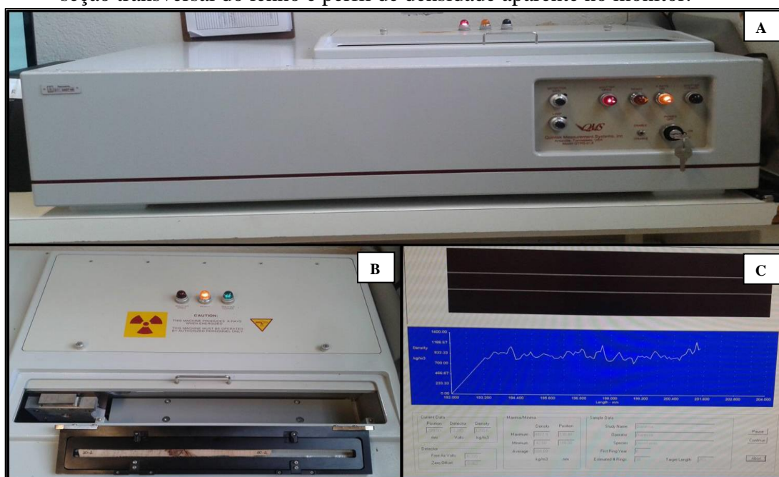
Figura 3 - Obtenção dos perfis de densidade. (A, B) equipamento de raios X QTRS-01X com o suporte metálico e encaixe com a amostra do lenho no compartimento de análise; (C) seção transversal do lenho e perfil de densidade aparente no monitor.
