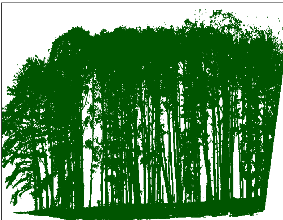
Figura 24 - Nuvem de pontos com remoção de outliers e pontos duplicados utilizando o aplicativo CloudCompare.
