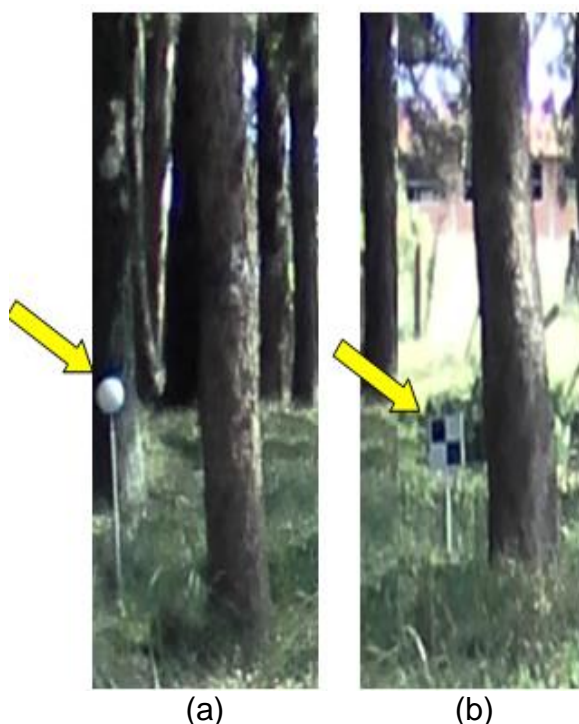
Figura 18 - Alvos utilizados no levantamento de dados. a) Alvo esférico; b) alvo plano.
