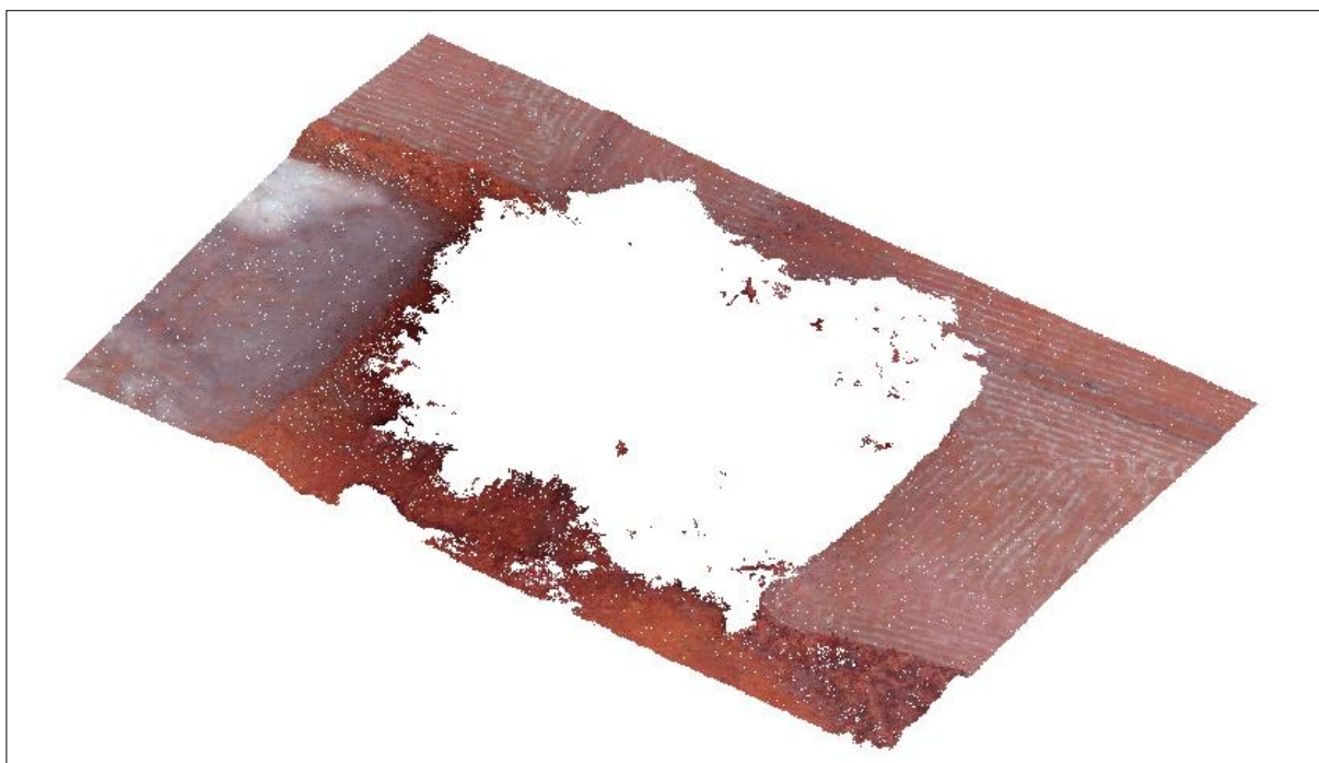
Figura 41 - Filtragem da nuvem de pontos fotogramétrica.
