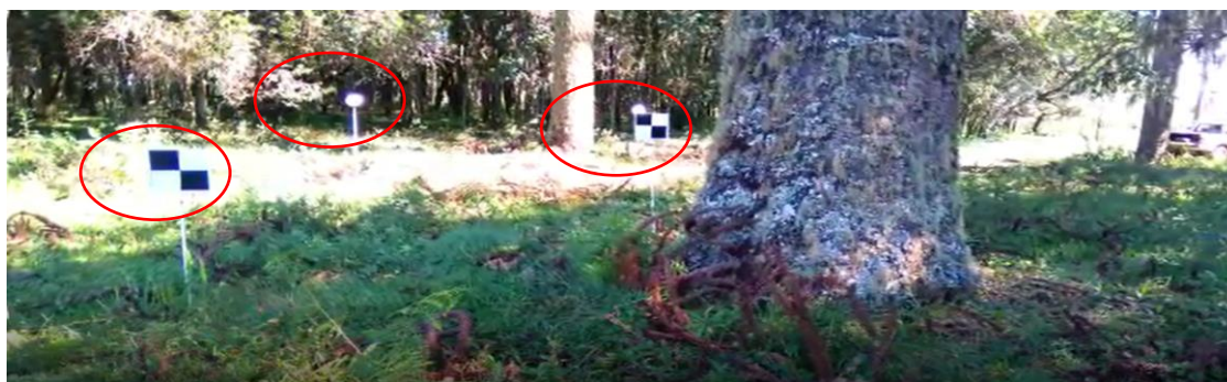
Figura 11 - Identificação dos alvos utilizados a campo para varredura Laser
