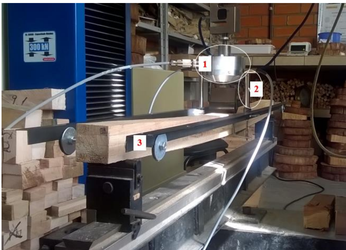
Figura 14 - Leitura do deslocamento no ponto de simetria da viga, em que (1) é a célula e carga, (2) é o transdutor de deslocamento posicionado no ponto de simetria e fixado na linha neutra (3).
