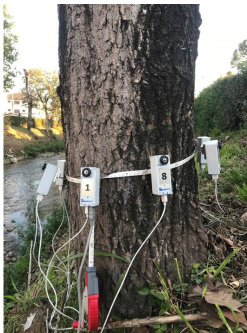
Figura 9 – Sensores do tomógrafo de impulso alocados ao longo da circunferência da árvore à altura de base (0,30m).
