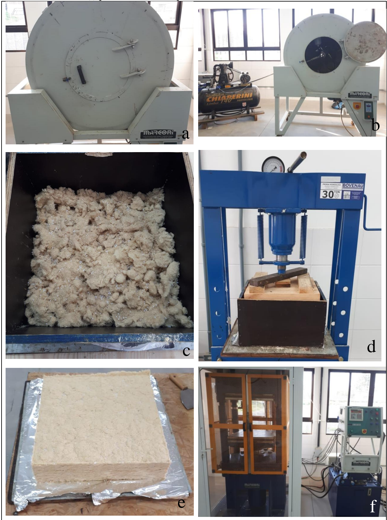
Figura 8 - Etapas do processo produtivo dos painéis. (a) encoladeira de tambor rotativo, (b) encoladeira com pistola acoplada ao compressor, (c) formação do colchão de fibras com adição manual do polímero, (d) prensagem à frio, (e) colchão de fibras, (f) prensa hidráulica aquecida.
