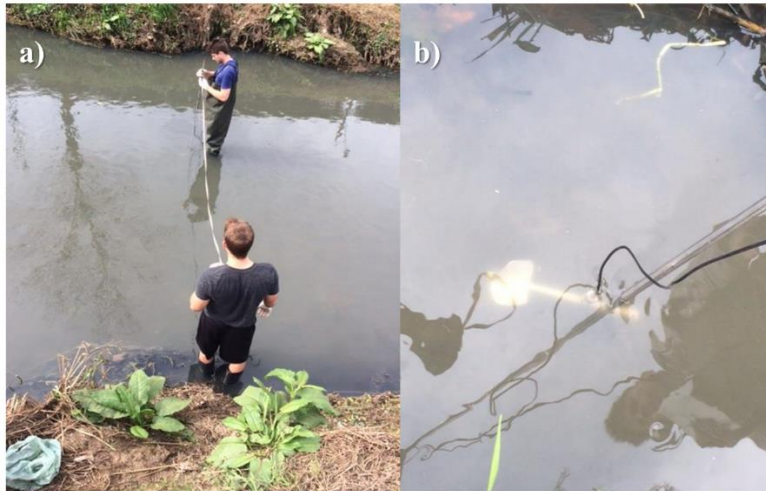
Figura 7 – (a) Medição da seção e altura da lâmina da água para determinação da área transversal e (b) posição do molinete no momento da medição.
