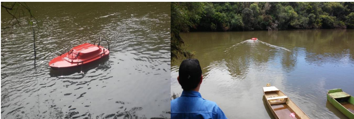
Figura 8 – Q-boat utilizado para a determinação da vazão do rio Carahá no ponto 15.
