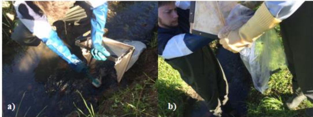
Figura 4 – a) coleta das amostras com amostrador do Tipo Surber e b) Transferência da amostra para sacos plásticos.
