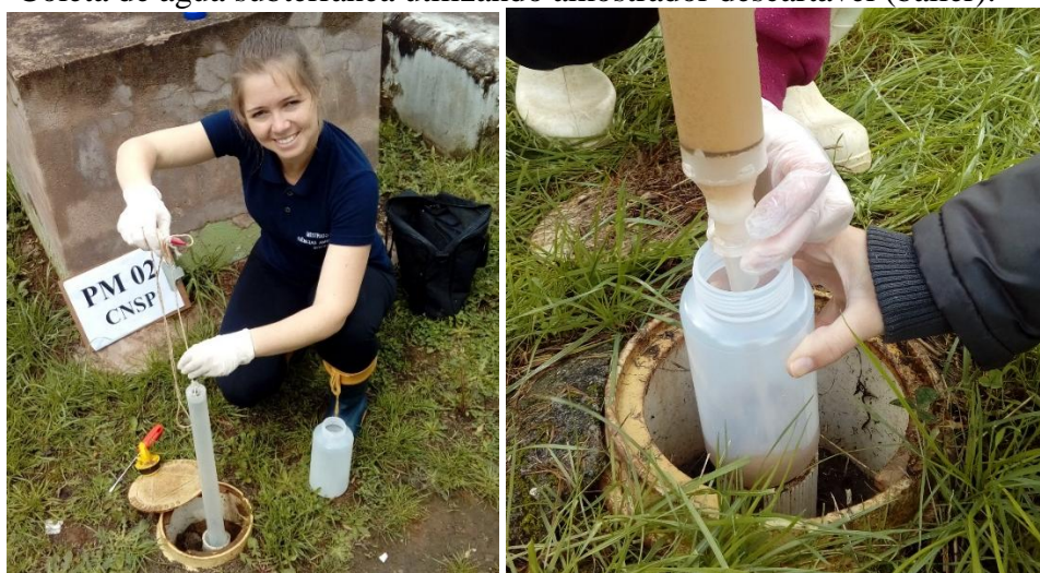
Figura 4 - Coleta de água subterrânea utilizando amostrador descartável (bailer).
