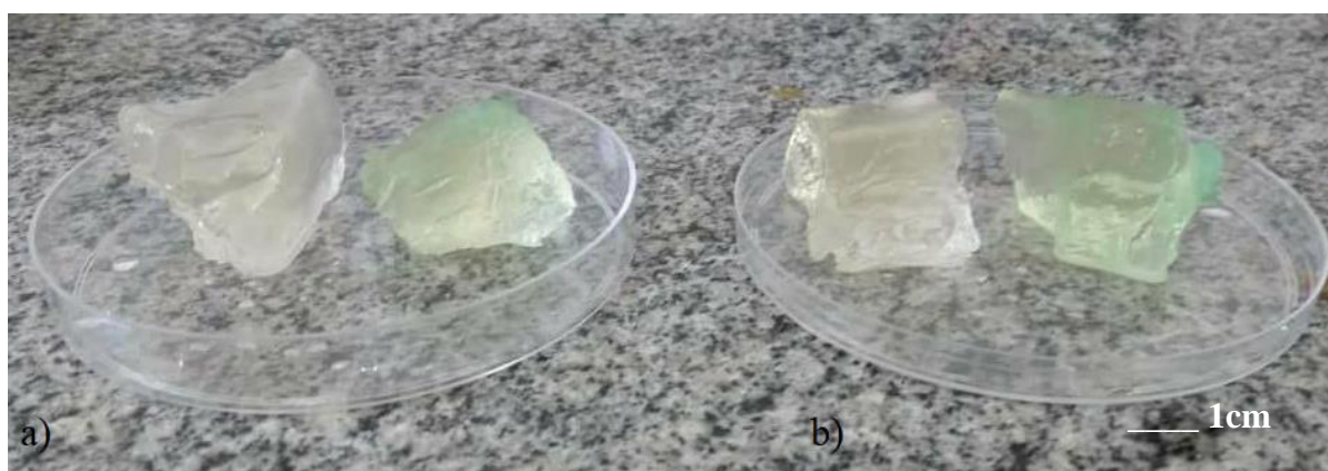
Figura 19 – Fotos do hidrogel compósito constituído de quitosana (hidrogel de QS) (a) e do hidrogel compósito constituído de quitosana/montmorilonita ativada (QS-H-MMT) (b) após estudos de adsorção de íons Pb^{2+} (a esquerda) e íons Ni^{2+} (a direita). Condições experimentais: tempo de contato de 24 h; massa de hidrogel 300,0 mg; pH da solução aquosa de 5,5; concentração inicial de 300,0 \text{ mg dm}^{-3} e temperatura ambiente.
