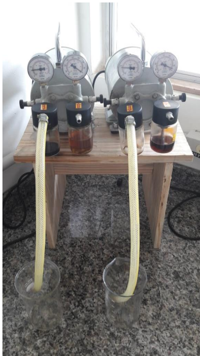
Figura 14 - Sistema de filtração utilizado em operação.
