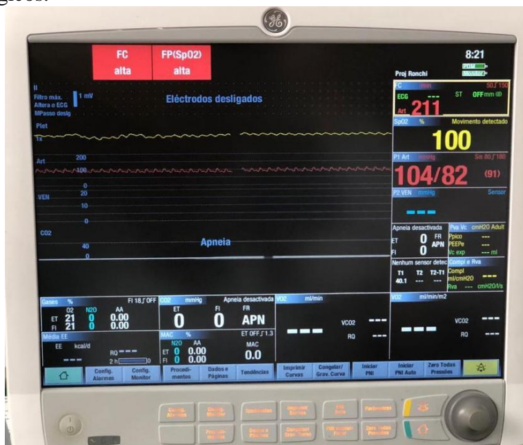
Figura 2 - Monitor multiparamétrico (Datex-Ohmeda 9100C), utilizado para monitoração dos parâmetros fisiológicos.
