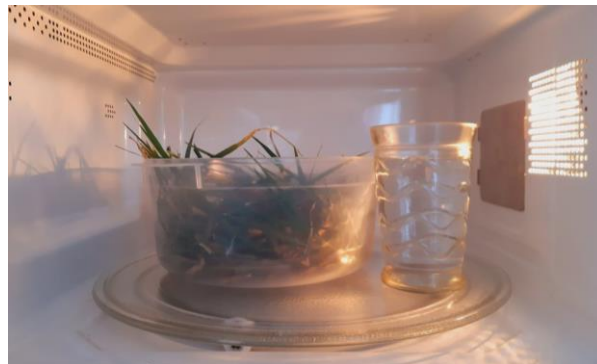
Figura 1. Secagem de amostra utilizando o micro-ondas. Fonte: Próprio autor, 2021.
