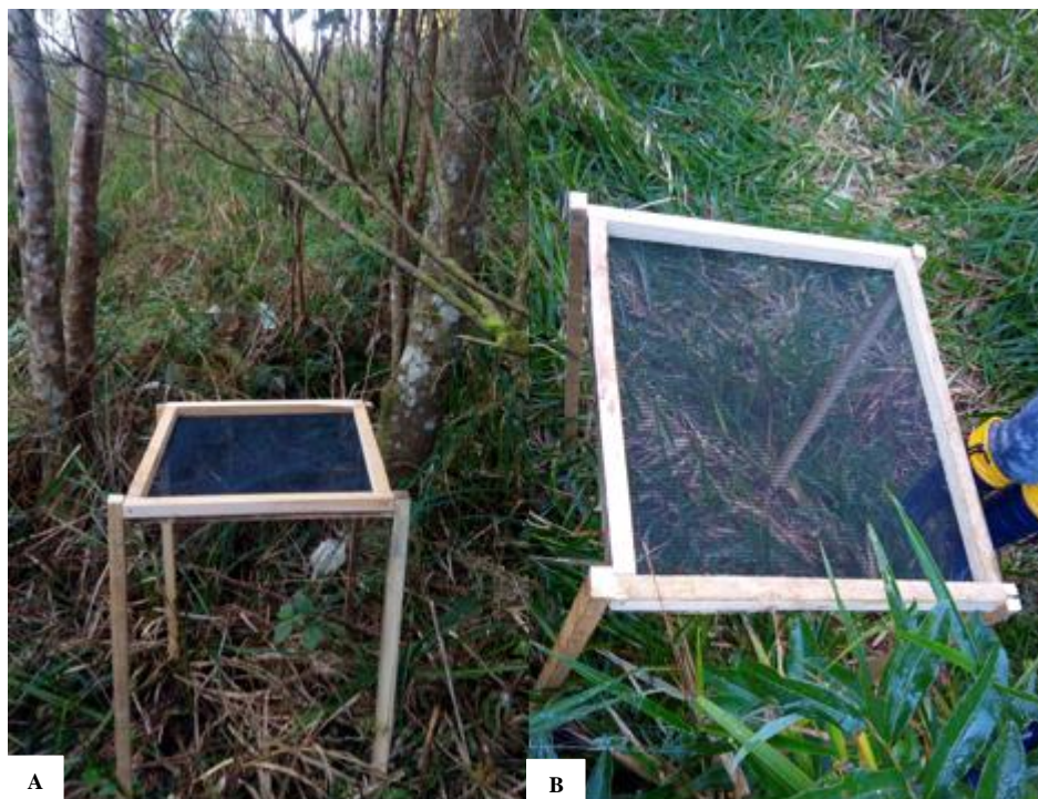
Figura 18 - Coleta da chuva de sementes e do aporte de serapilheira. A) Disposição do coletor no centro da unidade amostral; B) Coletor de madeira (50 cm x 50 cm) com rede de nylon ao fundo (2 mm de espessura) e altura de 1 m em relação ao chão.
