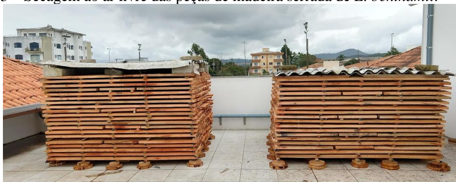
Figura 3 – Secagem ao ar livre das peças de madeira serrada de E. benthamii .
