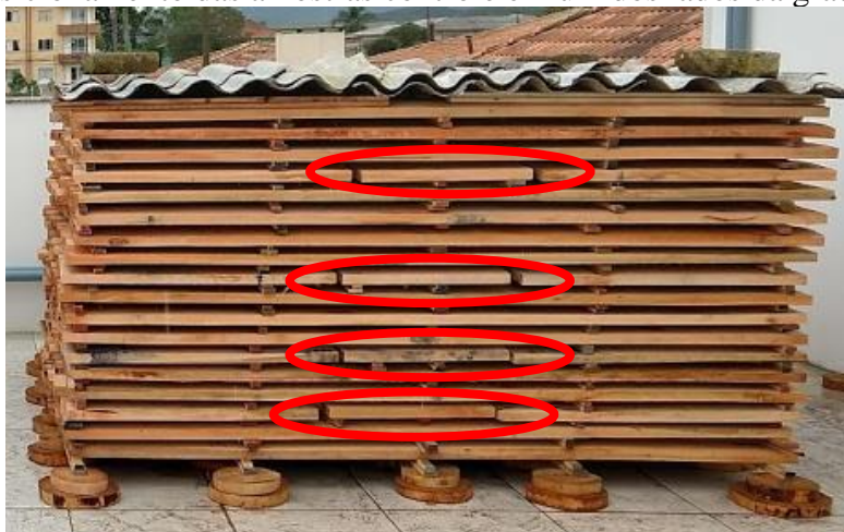
Figura 5 – Posicionamento das amostras controle em um dos lados da grade.
