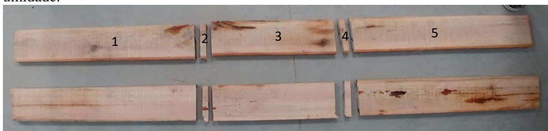
Figura 4 – Representação da confecção de amostras para monitoramento do teor de umidade.
