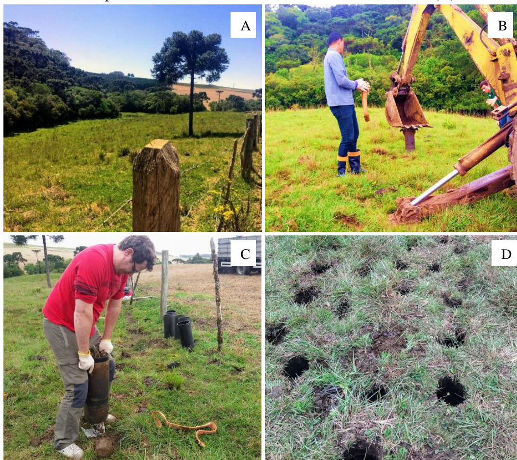
Figura 41 – Coleta de TMEs à campo: área da coleta (A); tubo coletor de aço sendo empurrado para o interior do solo pela retroscavadeira (B); remoção do TME de dentro do coletor de aço (C); distância entre os pontos de coleta das amostras indeformadas de solo (D).
