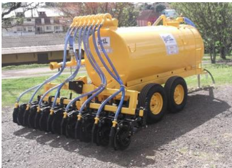
Figura 28 - Equipamento desenvolvido para injeção de dejetos líquido de animais pela parceria entre professores da Universidade de Passo Fundo – RS (UPF/RS) e a empresa MEPEL Ltda.
