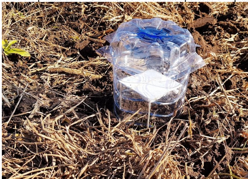
Figura 30 – Câmaras semiabertas com as espumas viradas para o solo a uma altura do solo de 8 cm atreladas em placas de PVC de 10x10 cm e estas apoiadas em quatro hastes.
