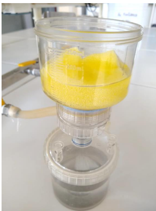
Figura 31 - Espumas lavadas com 250 ml de água destilada em funil de Buckner com placa porosa ligado a uma bomba de vácuo.
