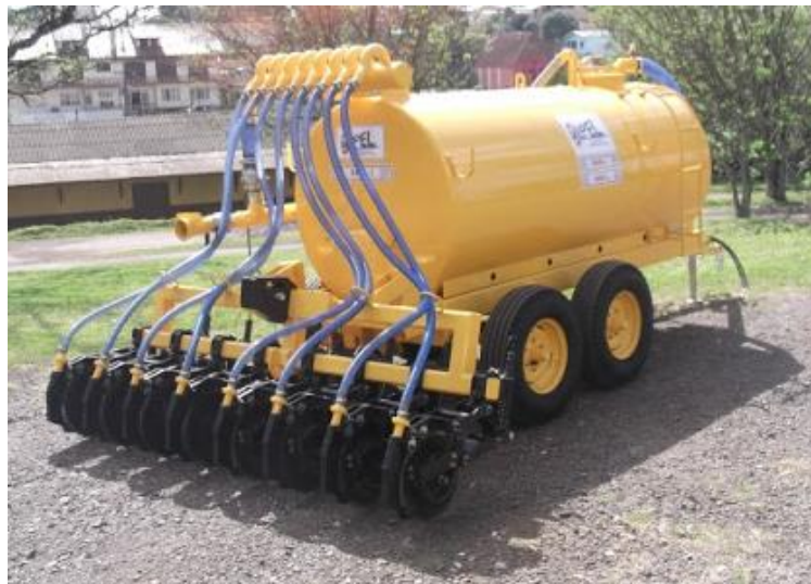
Figura 2 - Equipamento desenvolvido para injeção de dejetos líquido de animais pela parceria entre professores da Universidade de Passo Fundo – RS (UPF/RS) e a empresa MEPEL Ltda.
