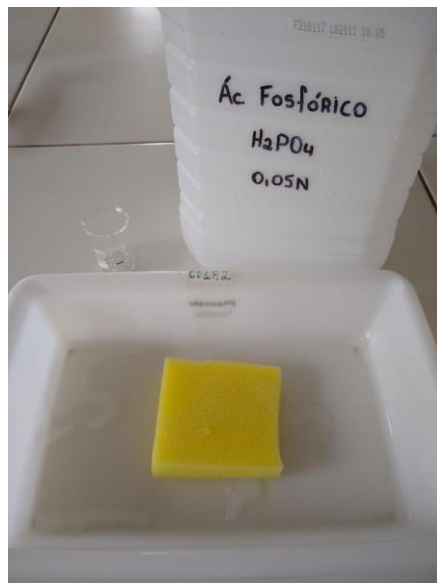
Figura 29 - Espumas absorvedoras de 8x8 cm e densidade de 0,02 \text{ g cm}^{-3} embebidas em 11ml de ácido fosfórico 0,05N.
