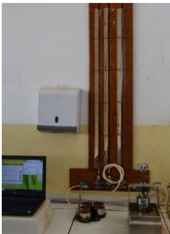
Figura 15 - Permeâmetro de carga variável para determinar a condutividade hidráulica saturada.
