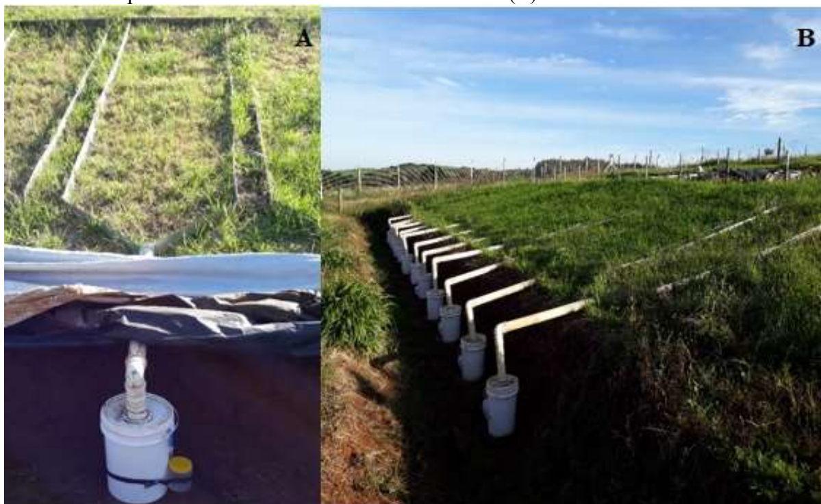
Figura 7 - Vista frontal de uma unidade experimental delimitada por chapas metálicas e seu respectivo coletor localizado na parte de menor cota (A) e vista lateral da distribuição das parcelas dentro da faixa de declive de 30% (B) em um Nitossolo.
