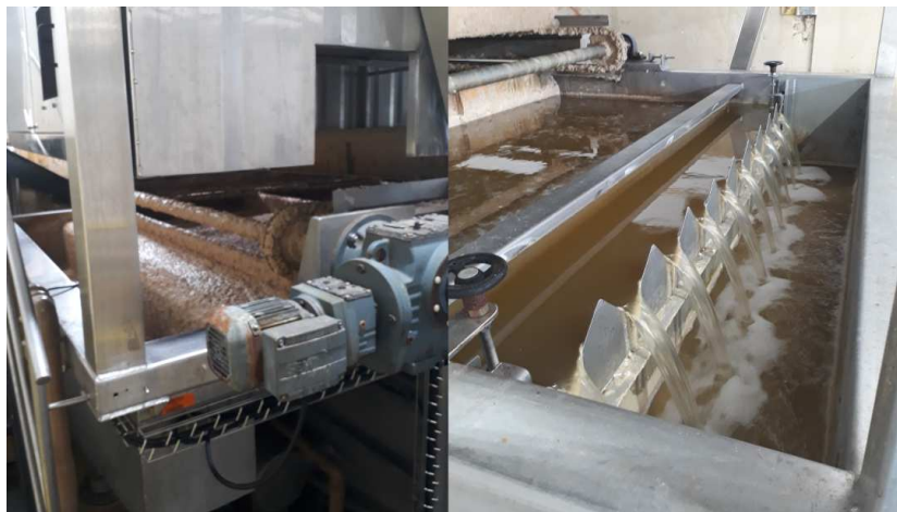
Figura 4 - Flotador e decantador primário em uma indústria de processamento de carne de frango. Fonte: Elaborado pelo autor, 2018.
