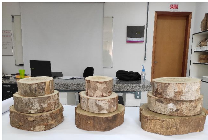
Figura 4. Discos nas posições 0%, 50% e 100% das árvores de Z. ekmanii no laboratório da UDESC.
