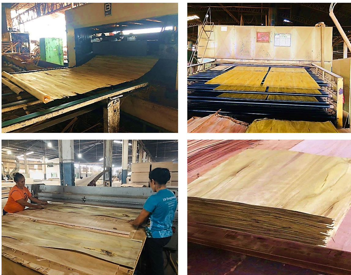
Figura 16. Laminação, secagem e preparo das lâminas de Z. ekmanii na empresa ParaFlorest, no Itinga-PA.
