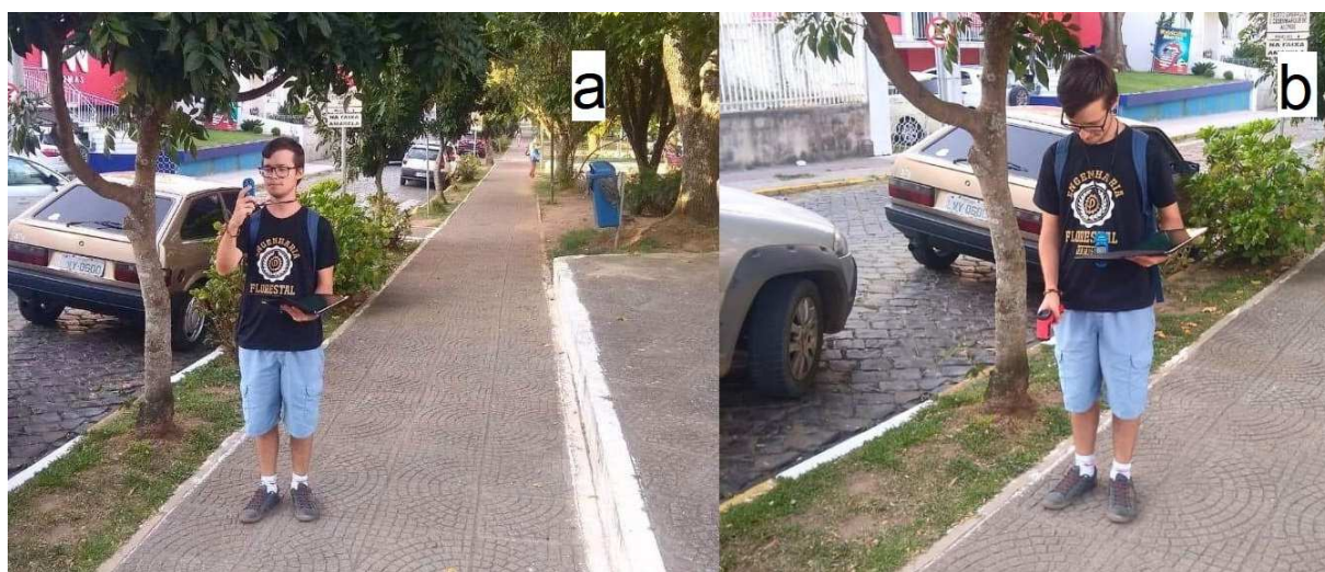
Figura 12: Utilização dos equipamentos de medições micrometeorológicas: a – Termo-higro-anemômetro KR825; b - Termômetro infravermelho KR380
