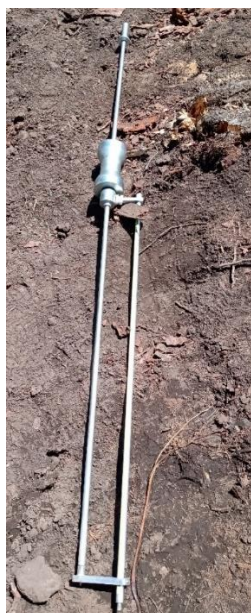
Figura 11. Penetrômetro dinâmico de cone (DCP) para determinação da variável de resistência a penetração (DN=mm/golpe).
