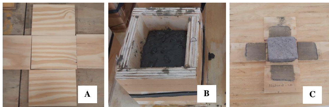
Figura 2 - Fôrmas para concreto. (A) composição das fôrmas de concreto; (B) fôrmas de concreto durante ensaio; (C) fôrmas de concreto após desmolde.
