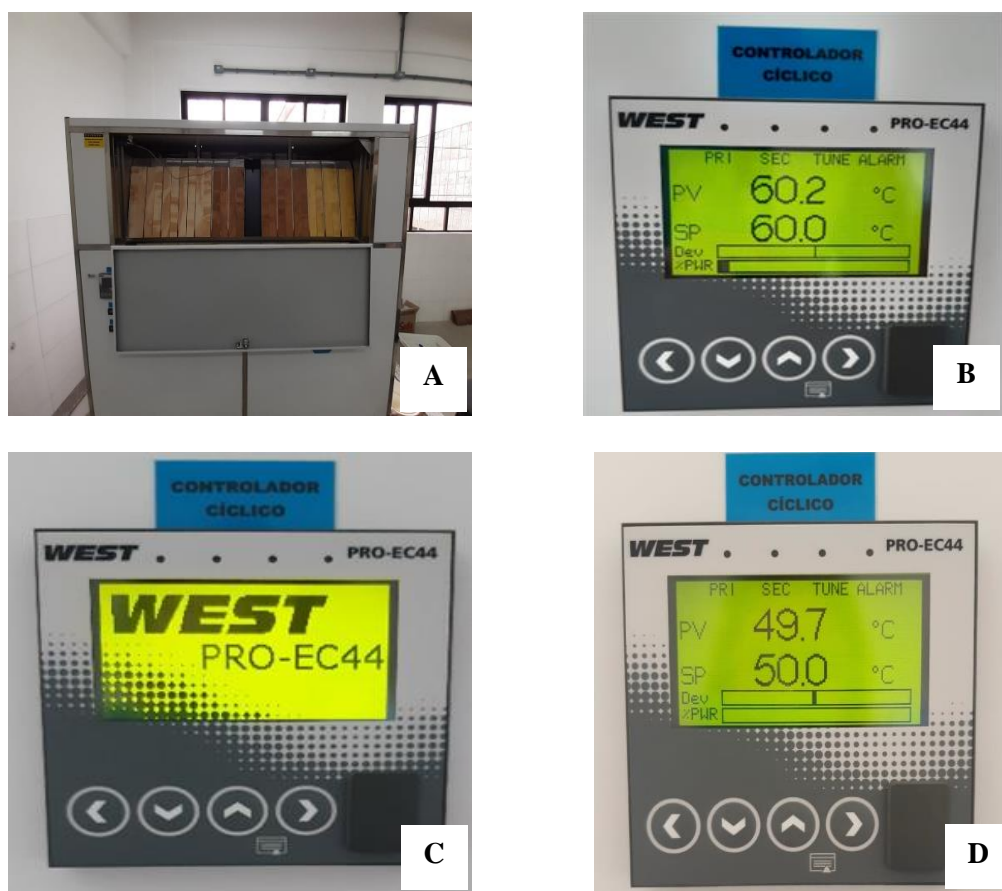
Figura 3 - Câmara de intemperismo acelerado. (A) Alocação dos corpos de prova, (B) 1ª fase – radiação, (C) 2ª fase – precipitação, (D) 3ª fase – condensação.
