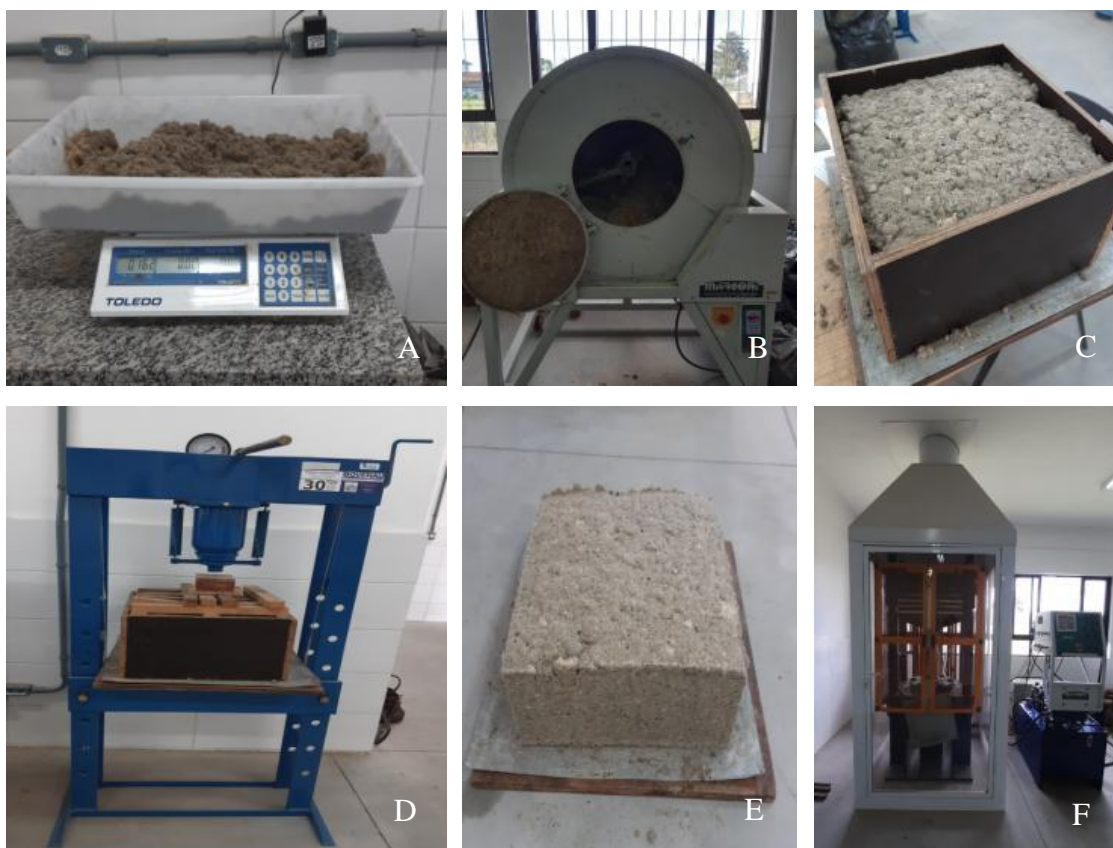
Figura 4 - Produção dos painéis. A) Pesagem das fibras; B) encoladeira tipo tambor rotativo; C) caixa formadora; d) pré prensagem a frio; e) formação do colchão; F) prensagem a quente.
