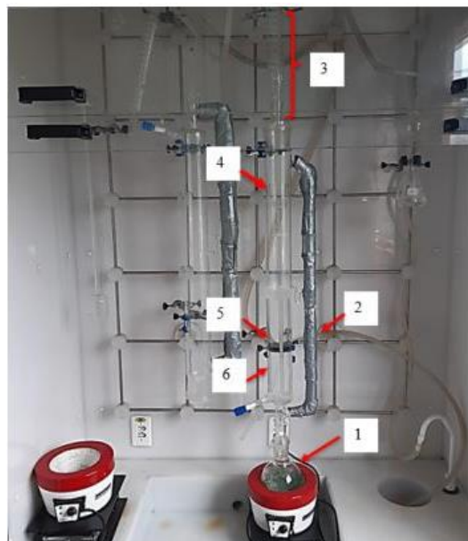
Figura 6 – Extrator de formaldeído - método perforator.1) Corpos de prova com o solvente; 2) tolueno com formaldeído extraído (fase gasosa); 3) condensador; 4) tolueno com formaldeído extraído (fase líquida); 5) tolueno (fase líquida); 6) água com formaldeído dissolvido.
